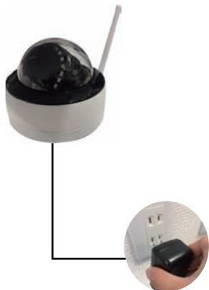
カメラへ付属電源アダプターを接続して、カメラを起動します。
