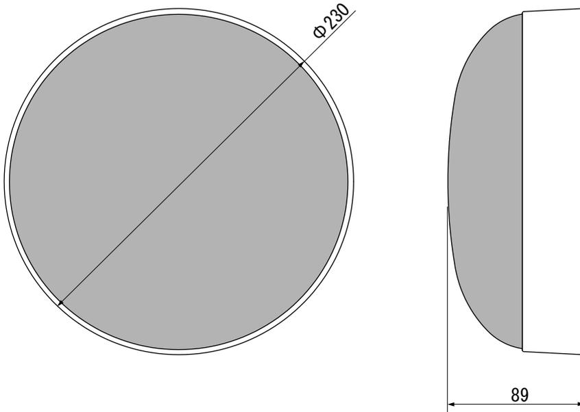
付属の取付金具を天井に取付け、スピーカ本体を取付金具に回転させて固定します。
