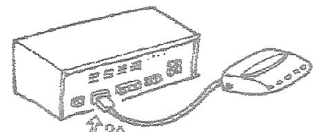
本機後面のACコンセント容量は2Aです。接続機器の容量を確認の上ご使用ください。
