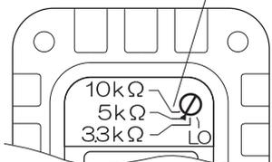
AV-635 IIを5kΩ(2W)接続した場合は、OE-L12の最大出力10W(Hi接続の場合)に対して4台までの接続が可能です(4台接続の場合は音量を上げ過ぎないように注意してください)。
