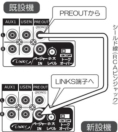
● 新設機の操作機能をロックできますので、既設機からのすべての操作が<Bエリア>に反映されます。
