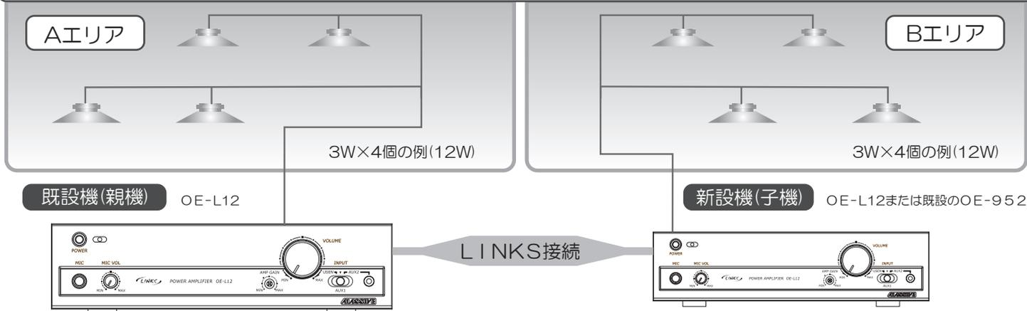
● Aエリア既設機の音量調整ボリューム及びマイクボリュームで、BエリアのBGM及びマイク(アナウンス)音量を調整できます。
